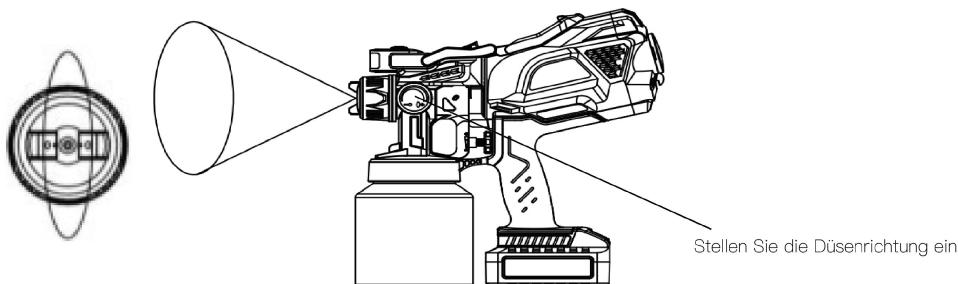
12) Ziehen Sie den Abzug, die Farbe wird aus der Düse gesprührt.
