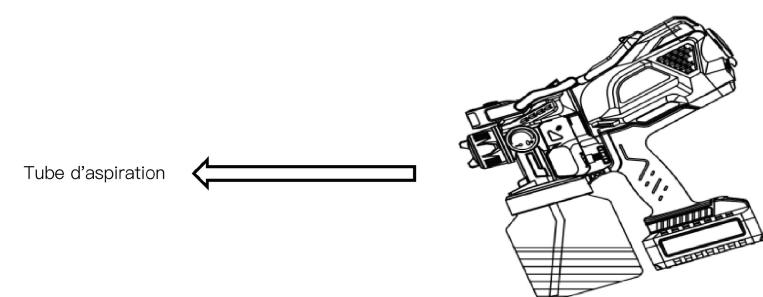
b) En cas de pulvérisation vers le bas, l'extrémité coudée du tube d'aspiration doit être dirigée vers l'avant du pistolet.
