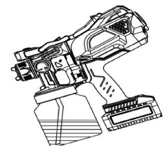
b) En caso de que se pulverice hacia abajo, el extremo en ángulo del tubo de succión debe apuntar hacia la parte delantera de la pistola.
