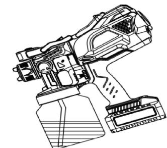
b) Wenn nach unten gespritzt wird, sollte das abgewinkelte Ende des Saugrohrs zur Vorderseite der Pistole zeigen.
