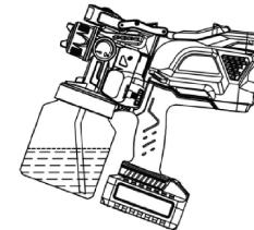
a) Beim Spritzen in Aufwärtsrichtung sollte das abgewinkelte Ende des Saugrohrs zur Rückseite der Pistole zeigen.
