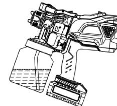
a) En caso de que se pulverice hacia arriba, el extremo en ángulo del tubo de succión debe apuntar hacia la parte trasera de la pistola.
