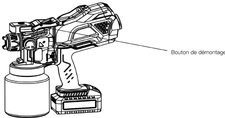
5) Connectez le corps du pistolet avec le moteur
