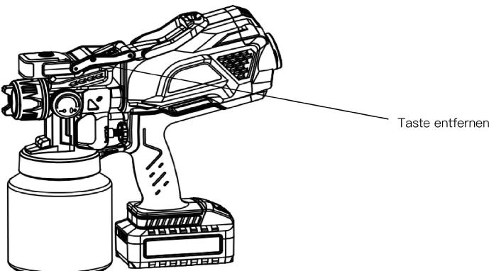
5) Pistolenkörper mit Motor verbinden
